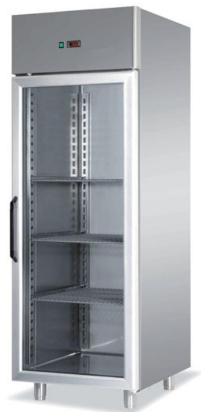
Armadio refrigerato TN in acciaio inox AISI 304 18/10, Lt.700, isolamento spessore 75 mm con 3 griglie plastificate da mm. 530x650, sbrinamento ed evaporazione condensa automatico, controllo digitale, anta in vetro. Temp. -2/+10°C dim. mm 710x800x2050 h - GV250
